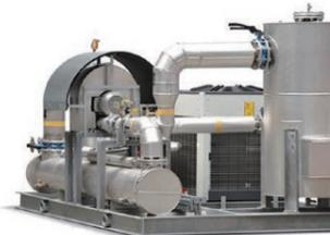
ガス処理装置は、主にバイオガス、埋め立てガス、炭鉱ガスなどの含水率をCHPユニットでの仕様に適したレベルまで下げることを目的としています。装置全体はベースフレームの上に設置します。ガスと接触する個々の部品、およびすべてのガス/流体パイプには、機械を保護するための断熱材が取り付けられています。
